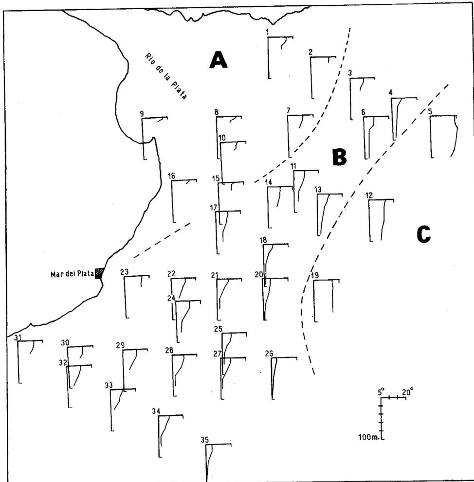
Gráfico N° 1; de 1 a 35: estaciones oceanográficas de Pesquería II; A, B y C: áreas hidrológicas; de 100 m a superficie: temperatura según batitermógrafo.
